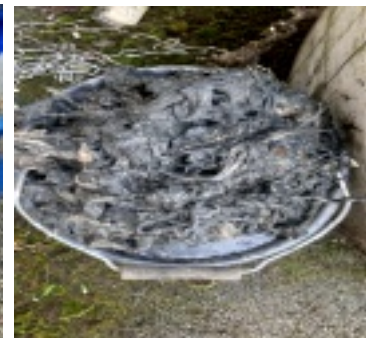
Les lingettes obstruent les pompes et entraînent un dysfonctionnement du système !
